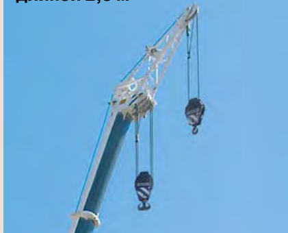
Монтажный удлинитель длиной 2,5 м
