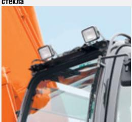
Дополнительные передние фонари освещения на крыше кабины
