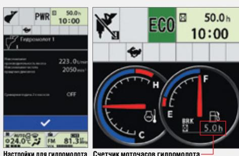
Настройки для гидромолота Счетчик моточасов гидромолота
