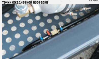
Кран слива отстоя из топливного бака
